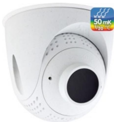
**PTMount-Thermal**は、IP65準拠、アクティブでコンパクト、目立たないドーム型で、3方向の調整が可能なPTマウントに、L43、L65、及びL135のレンズ付サーマルセンサーを内蔵したモジュールです。これにより、いつでも求める方向にセンサーを向けることができる非常にフレキシブルなシステムです。例えば、壁に取り付ける際にも、横向きのチルトで補い水平方向を調節し、対象エリアをカバーする最適な映像を可能にします。
