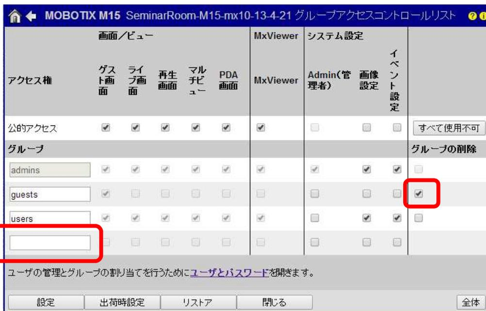
6. カメラへのアクセス時にユーザ認証を行う場合、「すべて使用不可」を押してください。公的アクセスのチェックがすべて外れたことを確認後、右下の「設定」ボタンを押してください。
