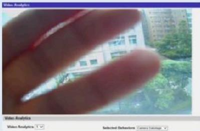
カメラのレンズがスプレーペイント、布、またはレンズカバーで覆われている場合、視野内のコントラストの変化を検出し、アラームをトリガーします。さらに、カメラの不正な再ポジショニングもアラームをトリガーします。
