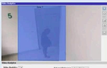
ユーザーが定義したゾーンに、定義した時間より長く留まり、移動しない人または車両を識別します。カメラは、ATM、階段の吹き抜け、学校の敷地内での疑わしい行動をリアルタイムで通知します。
