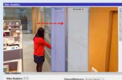
アラームをトリガーするためのシーンのユーザー定義ゾーンに入るオブジェクトを検出して追跡します。屋内と屋外の両方で、空いている場所に移動する複数のオブジェクトを追跡するのに適しています。動作は、雪、霧、風、雨などの監視環境の変化に徐々に適応することに注意してください。
